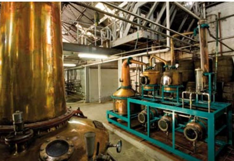
A l'origine, le rhum était distillé par le seul type d'alambic connu depuis le 16ème siècle : l'alambic à repasse. Il nécessite une double opération de chauffage. La première (chauffage du moût fermenté) permet d'obtenir un alcool léger (entre 25 et 30%) qui va être ensuite soumis à une deuxième chauffe. On obtient alors une eau-de-vie titrant 70% d'alcool, dont on ne garde que la partie centrale (le cœur), en éliminant le début (les têtes) et la fin (les queues).
